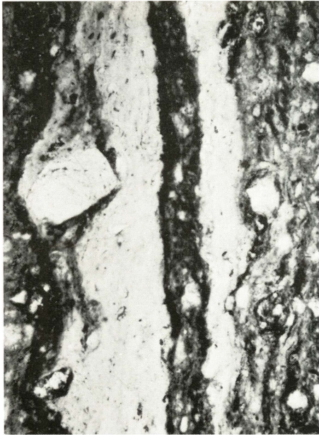
Abb. 17 Mikroskopischer Dünnschliff durch eine glasig erstarrte, blasenfreie Kruste mit hellen und dunklen 0,05 — 0,2 mm breiten Schlieren. Vergrößerung 85 x.
